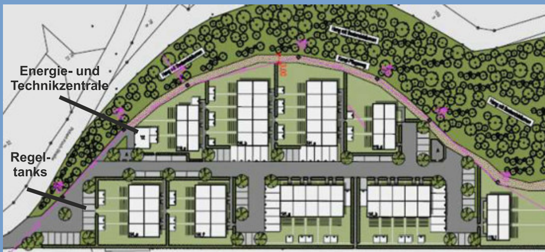
Das Baugebiet in Alzey. Die Regel-tanks sind unterirdisch verbaut.
